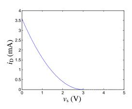
$$i_D = \frac{1}{2} k_n (v_{GS} - V_t)^2, \ v_{GS} = V_{DD} - v_s$$
