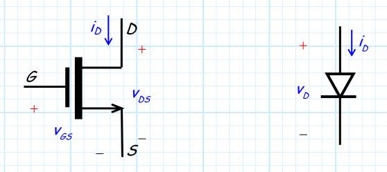
$$i_D = K \left[ 2 \left( v_{GS} - V_t \right) v_{DS} - v_{DS}^2 \right]$$
